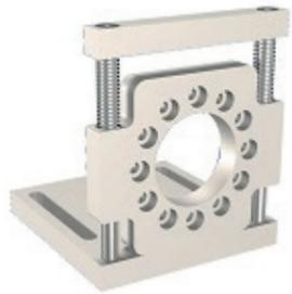
Hochwertig hergestellter federnder Montagewinkel für die Drehgebermontage in Verbindung mit einem Messrad von 12 Zoll oder 500mm Umfang, verschieden angebrachte Befestigungsbohrungen ermöglichen die **optimale Positionierung des Drehgebers**. Die sorgfältig abgestimmte Federung garantiert einen permanenten Andruck des Messrades an das Objekt.
